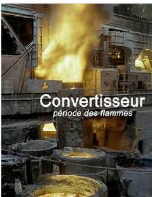
La fonte blanche est ensuite refondue dans une **station d'affinage** où on retire ses impuretés pour former de l'acier, à l'intérieur d'un **convertisseur**.
