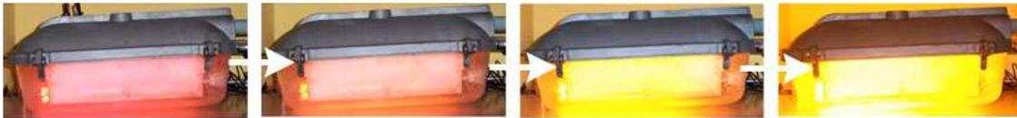
Lorsque l'interrupteur est fermé, ou lorsqu'une photodiode permet à la lampe de s'allumer dans le cas des lampes d'éclairage routier, l'amorceur (→ voir "Platine d'alimentation") envoie un pic de tension élevé, suffisant pour que l'électricité passe au travers de la lampe.
