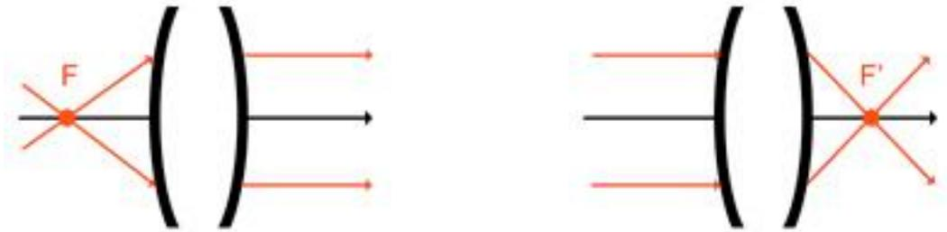
à Tout faisceau incident issu d'un foyer secondaire donné émerge en un faisceau parallèle.
